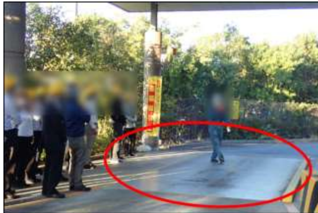
写真4 トラックの計量を行うはかり（赤丸）
