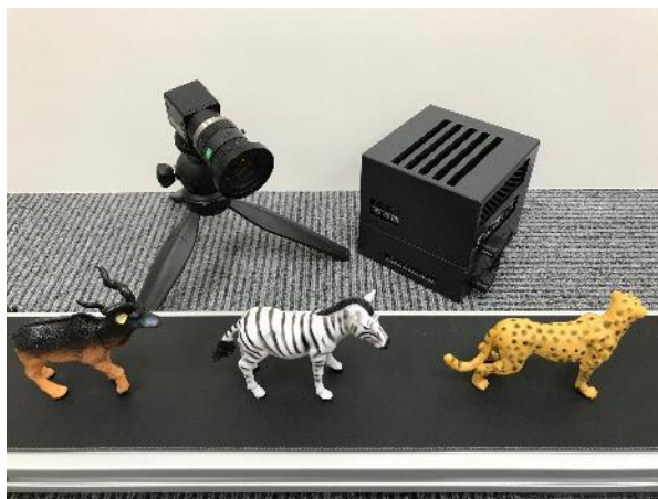
① IoT機器を生産ラインに設置し、商品カメラで撮影
