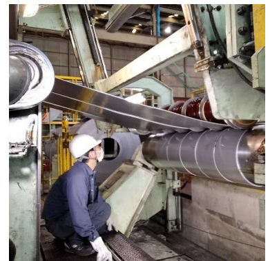
裏面目視検査
