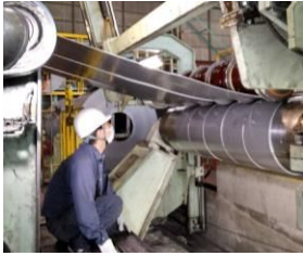
装置内での目視検査、安全性に課題あり
